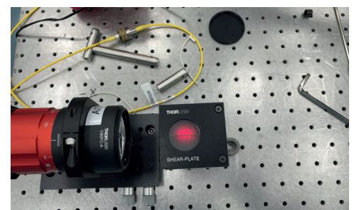
Réglage du collimateur en salle blanche
